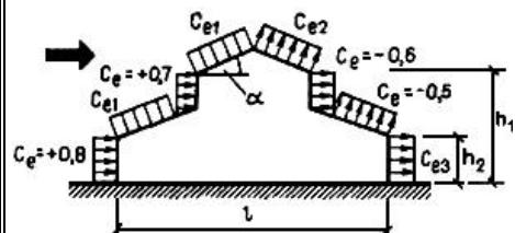
Коэффициенты  $c_{e1}$ ,  $c_{e2}$  и  $c_{e3}$  следует определять в соответствии с указаниями к схеме 2
