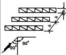
Для наветренной конструкции коэффициент  $c_{x_1}$  определяется так же, как для схемы 15.
