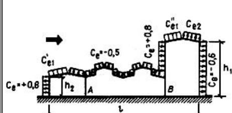
Коэффициенты  $c'_{e1}$ ,  $c''_{e1}$  и  $c_{e2}$  следует определять в соответствии с указаниями к схеме 2, где при определении
