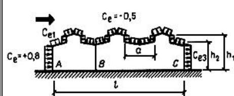
Для покрытия здания на участке  $AB$  коэффициенты  $c_e$  следует принимать по схеме 4.
