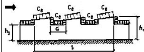
Для наветренного фонаря коэффициент  $c_e$  следует определять в соответствии с указаниями к схеме 2, для остальной части покрытия - как для участка  $BC$  схемы 5
